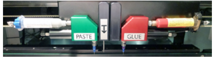
FIGURA 1. Dispensador de soldadura en pasta montado dentro de una impresora de esténcil
